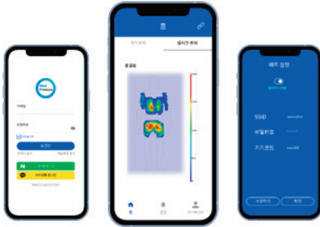
그림 2 메디프레슈어의 어플리케이션의 내부 화면. 현재 누워있는 환자의 압력 현황을 확인할 수 있음.
